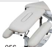
Art.-Nr. 056 Kopf 3-teilig mit Armstützen, stufenlos absenk- und abnehmbar, Verstellbereich -25° bis +45°, Art.-Nr. 010K nicht möglich, Abmessungen: Kopfteil: L 540 mm x B 370 mm Armteil: L 500 mm x B 160 mm
